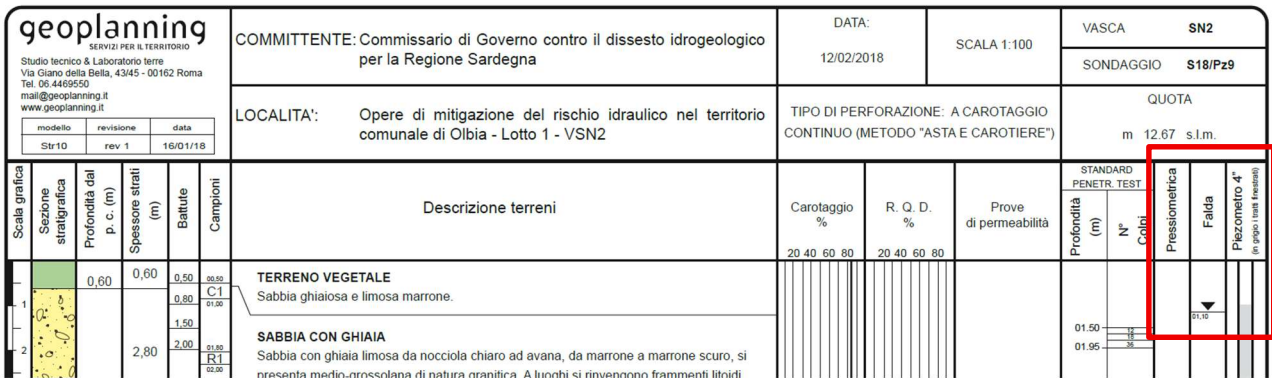
Figura 23-21 - Sondaggio S18-pz eseguito presso la vasca di laminazione del riu san Nicola ed indicazione del livello di falda rilevato nel piezometro
