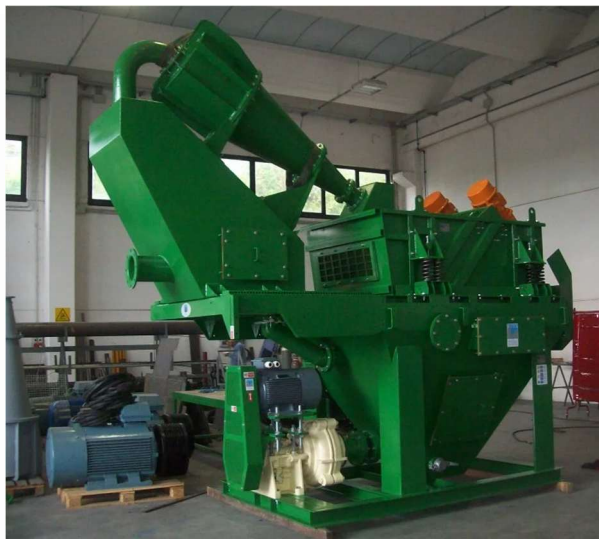
Figura 11-15 - Esempio di idrociclone compatto per lavaggio sabbie (capacità massima Q=360 \text{ m}^3/\text{h} )
