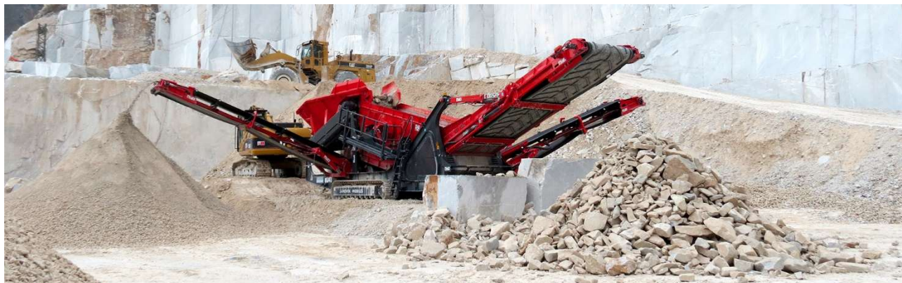
Figura 14-15 - Vaglio mobile per la separazione delle sabbie ed il pietrischetto dai ciottoli per scogliera
