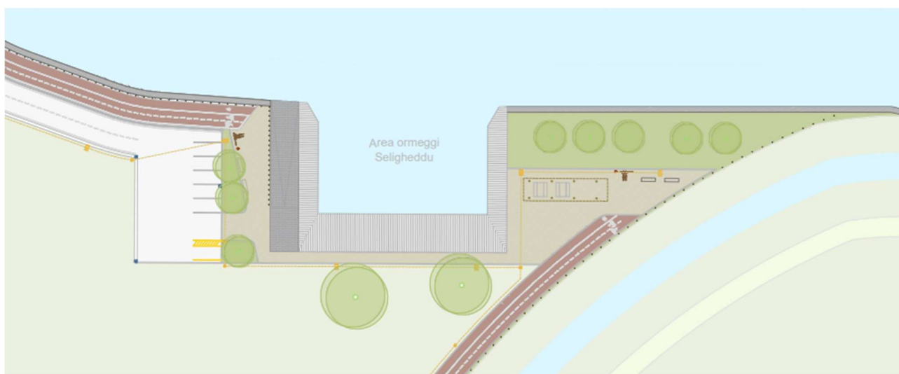
Figura 23-37 - Pianta della zona di ormeggio lungo la riva destra del riu Seligheddu. Si noti a destra il ramo del deviatore del riu Tannaule in ingresso al riu Seligheddu, poco a monte del ponte ferroviario
