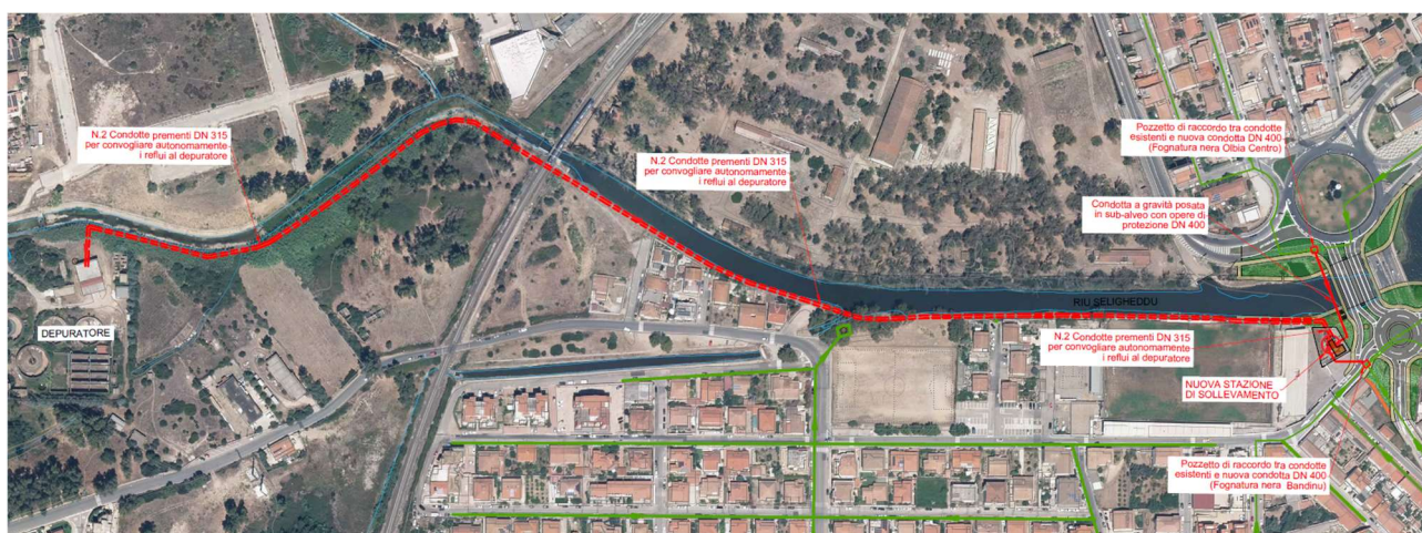
Figura 10-54 – nuovo schema idraulico della rete fognaria nei pressi del ponte di via Roma
