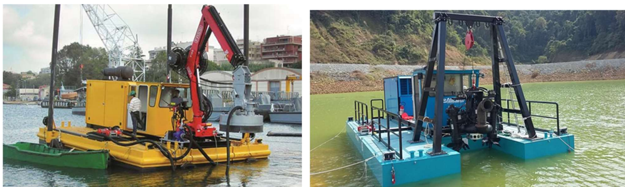
Figura 10-41 - Esempio di piccoli pontoni dotati di draga/sorbona
