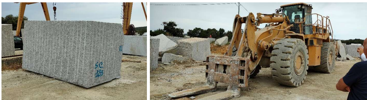
Figura 14-4: A sinistra, blocco di granito concluso e pronto per essere immesso nel mercato. A destra, benna a forza per carico e scarico dei blocchi
