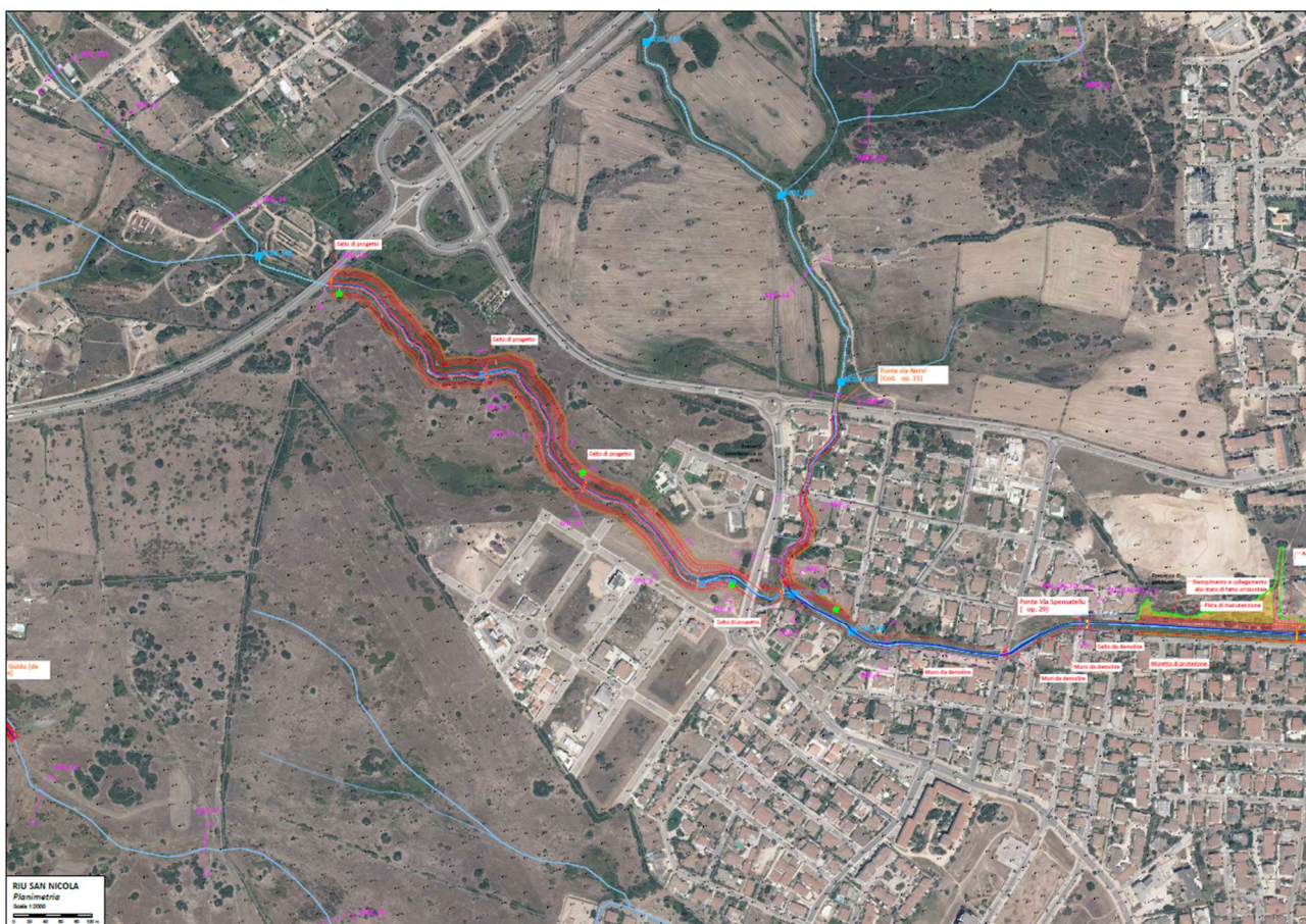
Figura 10-11 - Interventi di risezionamento lungo il riu san Nicola – tratto di monte
