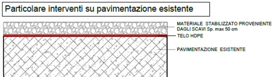
Figura 11-17 – Legenda della tavola descrittiva dell’allestimento della banchina Cocciani per il trattamento di sedimenti dragati e terre salate
